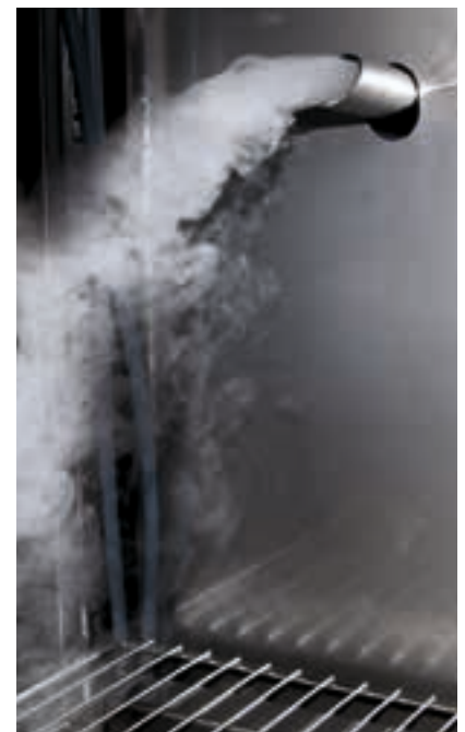
Aerosolnebel ohne Wärmeeintrag in den Prüfraum.
