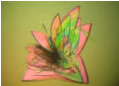
Proteinkristalle sind sehr fragil: Vibrationsfreiheit ist eine Voraussetzung dafür, dass sie sich bilden können.
