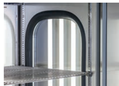
Viel Licht, aber nicht zu viel Wärme: Diese Leuchtstoffröhren sind thermisch vom Prüfraum getrennt.
