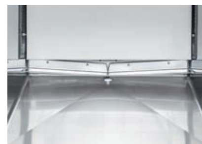
Prüfraumboden mit Gefälle zum Kondensatablauf.
