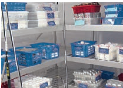
Stabilitätsprüfung von Medikamenten nach ICH-Guideline in der Klimakammer.
