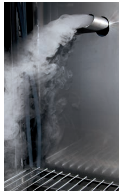
Aerosolnebel ohne Wärmeeintrag in den Prüfraum.
